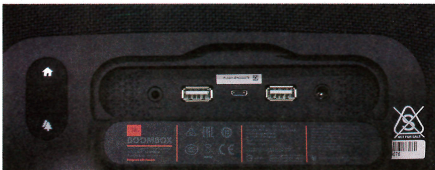
Sul retro troviamo un tasto per selezionare la modalità di utilizzo, all'aperto o in casa, con relativa equalizzazione. Al riparo di uno sportellino stagno ci sono due prese di ricarica USB e l'ingresso linea mini-jack, oltre ad una presa di servizio e alla connessione per l'alimentatore/caricabatterie.
