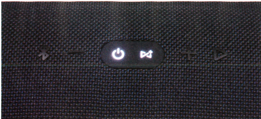
Sulla parte superiore del Boombox, in posizione centrale, ci sono i tasti per il controllo dell'apparecchio. Il tasto play può essere configurato per attivare l'assistente vocale.
