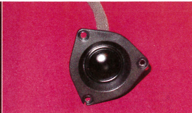
Essendo a tenuta stagna, non è stato possibile accedere all'interno del Boombox per osservarne la costruzione, ma in occasione della presentazione del prodotto alla Convention EISA ci hanno mostrato i driver utilizzati, ai quali si affiancano i due radiatori passivi visibili esternamente.
